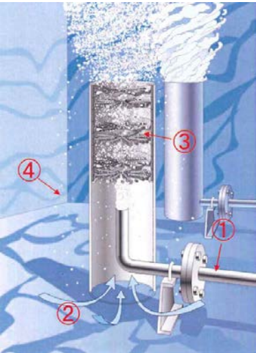
図 3 散気管の仕組み(アクアブラスター)
