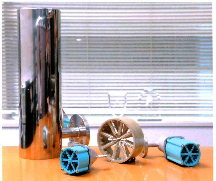
青い部品がアクアブラスターのプロア。筒の上部に微細気泡発生装置（右から2つめ）を設置する
